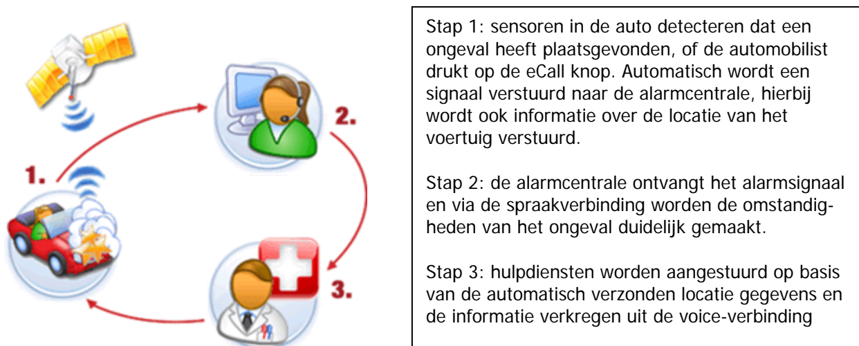
Figuur 2.1 Eenvoudige weergave van werking van eCall 2
